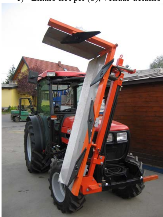
Slika 12: Vršičkar za striženje listne stene in vrha (Foto: Balon, 2006).
