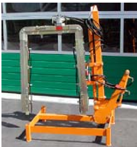
Slika 13: Vršičkar za striženje listne stene vrha in nasprotne stene (Foto: Balon, 2006).
