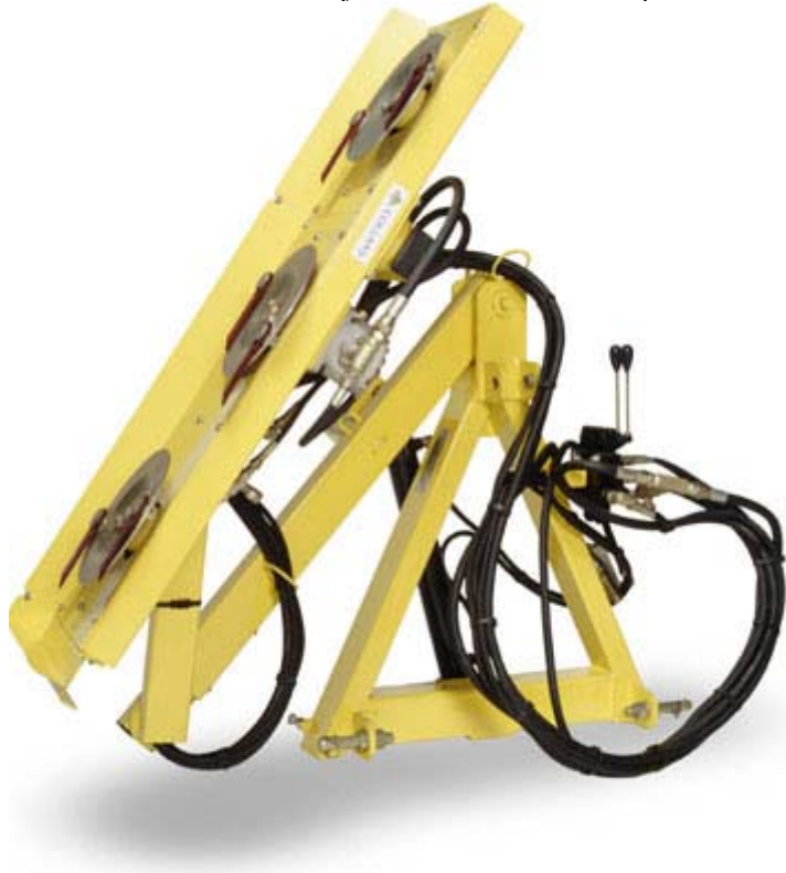
Slika 14: Primer vršičkarja s krožnikom, na katerem so pritrjeni noži (Bubco, 2007).
