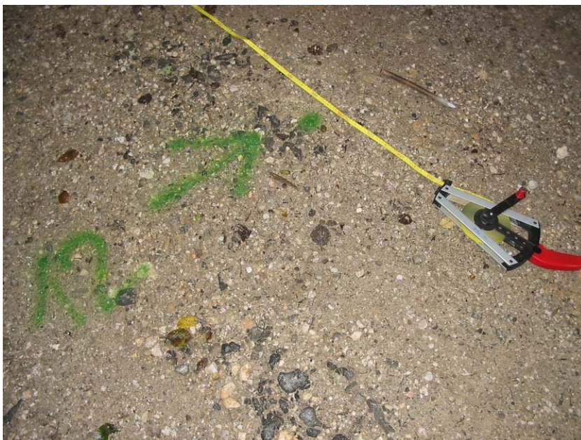
Slika 22: Označba točke na terenu (Foto: Baškovč, 2006)
