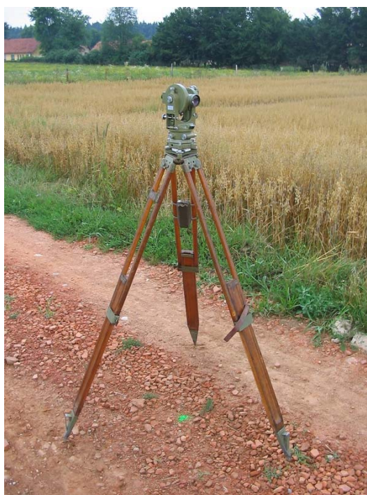
Slika 23: Wild RDS postavljen na točko (Foto: Baškovč, 2006)
