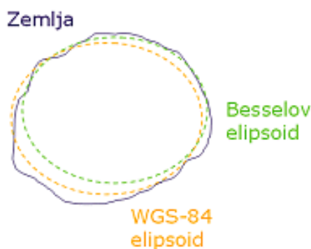
Slika 18: Primerjava med Besselovim in WGS-84 elipsoidom ( www.geosistemi.si )
