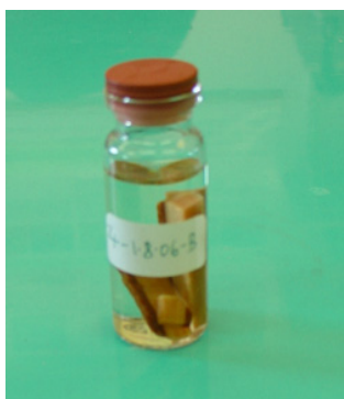
Slika 2: Obdelani količki v 15 ml penicilinki s 70 % etanolom (Prislan, 2007).
