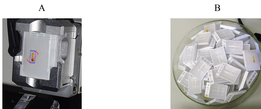
Slika 3: A - Pravilna orientacija vzorca v kaseti za optimalno kakovost preparatov. Moder okvir prikazuje običajno orientacijo vzorcev, rdeč pa boljšo orientacijo vzorcev pod kotom 45°; B – Končni izgled vzorcev vklopljenih v parafin (Prislan, 2007).
