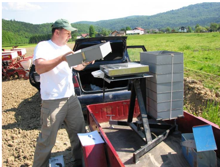
Slika 20: Stresalna naprava za merjenje strukture talnih delcev (foto: Primož Berus, 2008)
