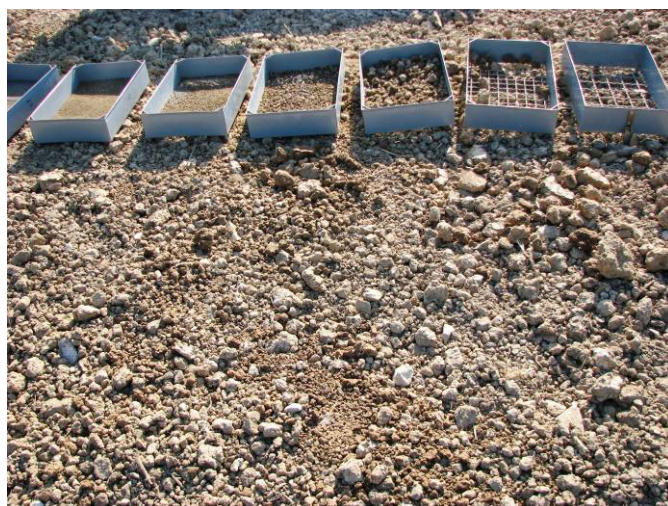
Slika 21: Osem okvirjev z različno velikimi siti (foto: Primož Berus, 2008)
