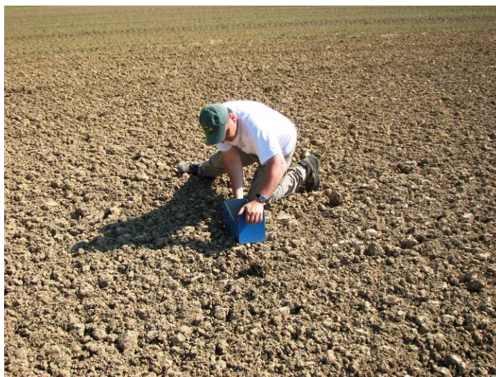
Slika 19: Odvzem vzorca s posebno lopato (foto: Primož Berus, 2008)
