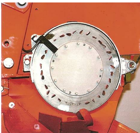
Slika 5: Kontrola padanja semena na sejalni plošči (Kverneland ..., 2010)
