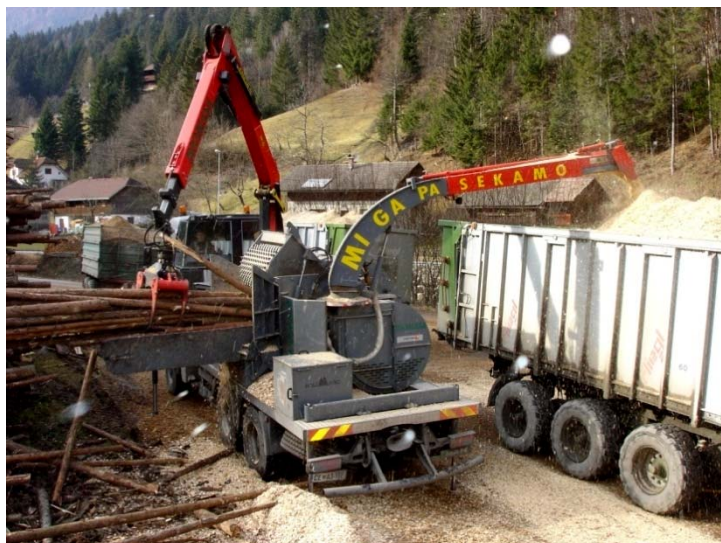
Slika 16: Izdelava lesnih sekancev na centralnem skladišču
