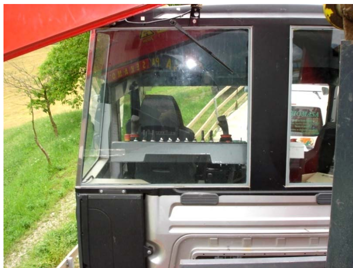
Slika 13: Adaptirana kabina s prozorno zadnjo steno, komandnim pultom in sedežem
