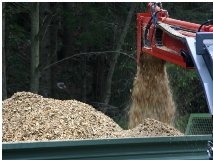
Slika 17: Masovno izletavanje sekancev iz izletne odprtine na prikolico
