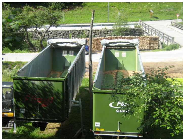
Slika 8: Flieglovi prikolici za volumensko izmero lesnih sekancev
