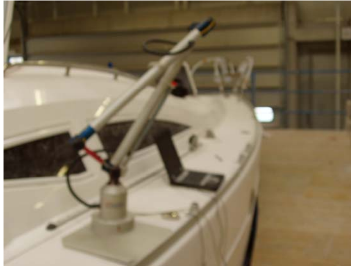
Slika 8: Digitalizator za odčitavanje oblike palube
