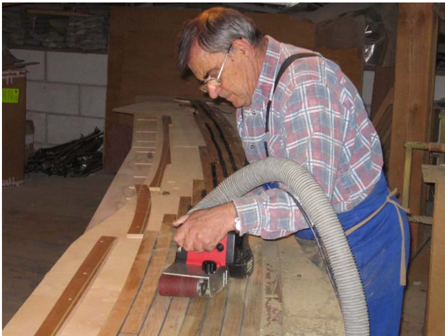
Slika 28: Grobo brušenje obloge
