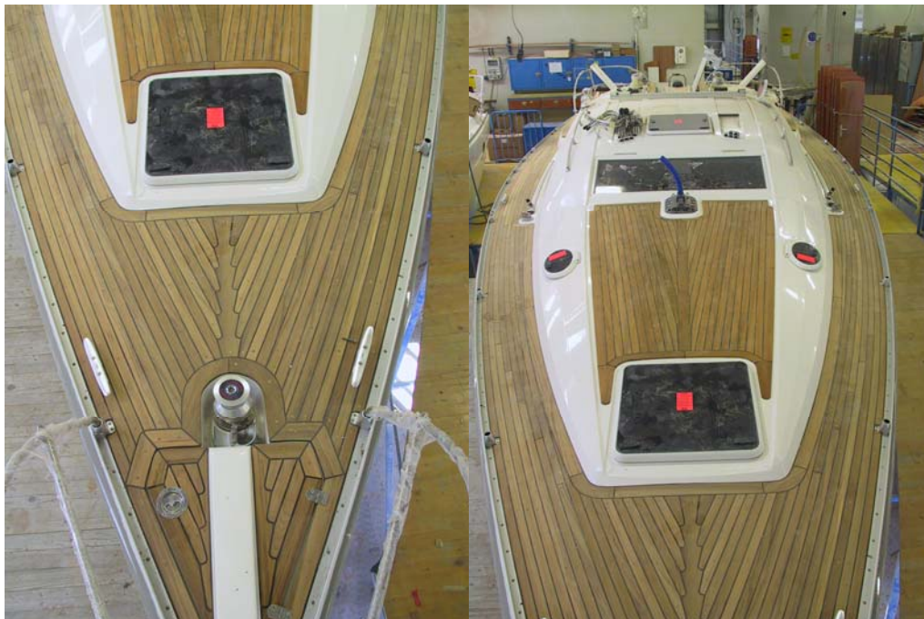
Slika 46: Končni izgled montirane tikove obloge
