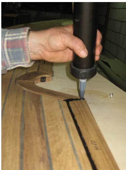
Slika 32: Tesnjenje špranj stranskih elementov
