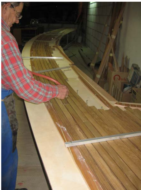
Slika 25: Čiščenje obloge s stisnjnim zrakom
