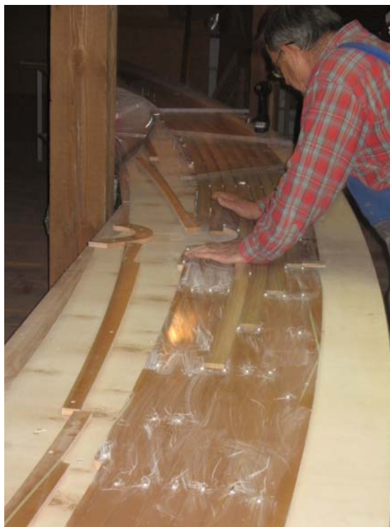
Slika 24: Dodatna pritrditev tikovih letvic
