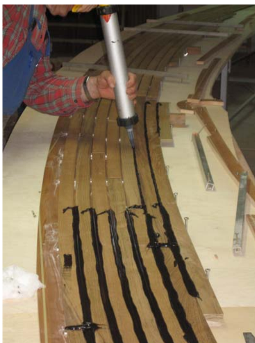
Slika 26: Tesnjenje špranj s tesnilno maso Sikaflex
