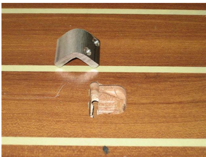
Slika 18: Kovinski kotnik za pritrjevanje tikovih letvic(distančnik)
