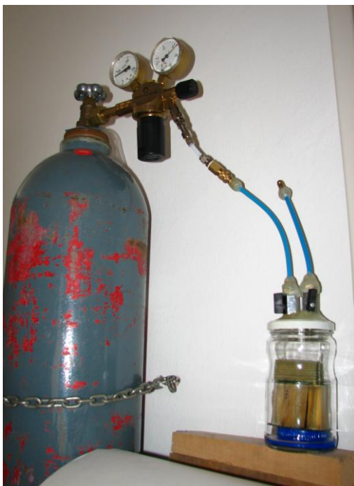
Slika 7: Preprihovanje vzorcev z argonom
