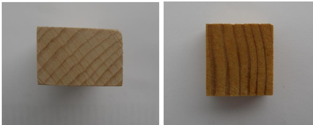
Slika 4: Razrez vzorcev: levo vzorec večjih dimenzij – letnice pod kotom  $45^\circ$  glede na osnovno ploskev; desno vzorec manjših dimenzij – letnice pravokotno glede na osnovno ploskev
