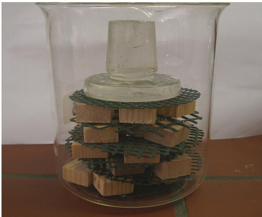
Slika 7: Način namestitve vzorcev v čašah za modifikacijo ali za spiranje ali za določitev ASE koeficienta
