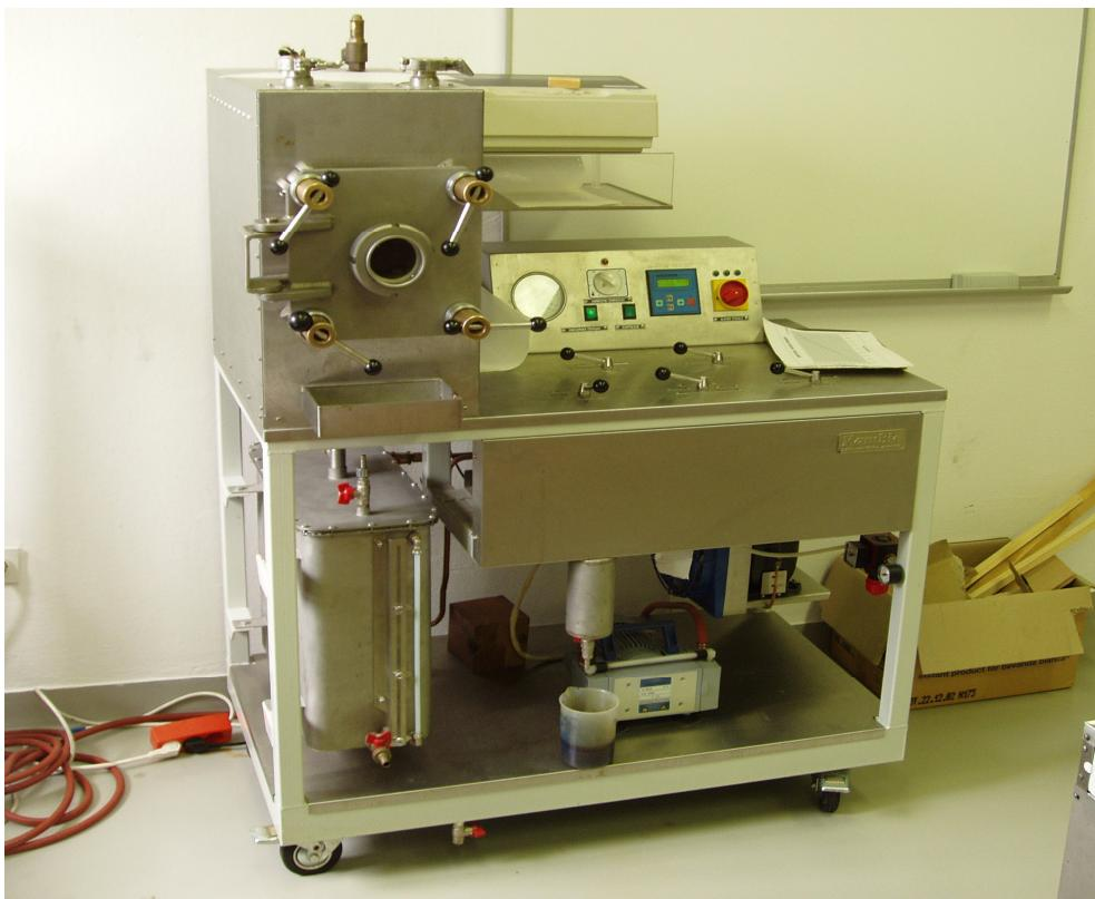
Slika 8: Vakuumsko-tlačna komora
