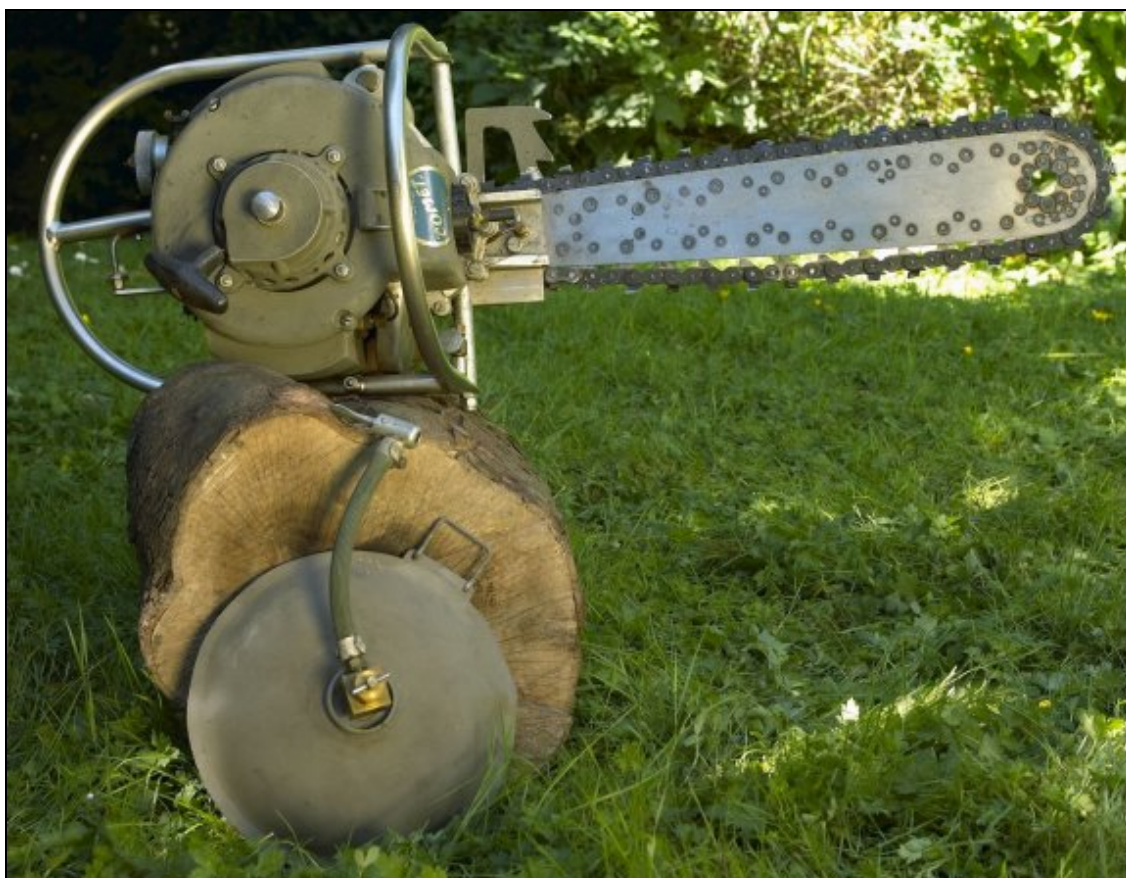
Slika 45: Comet S (tretja različica prve motorne verižne žage na diesel pogon) s posodo, kjer je shranjen propan (Chain saw collectors corner, 2007)
