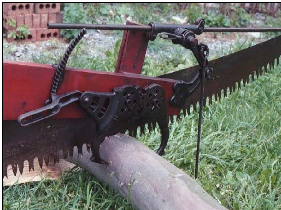
Slika 9: Patentirana objemka in napetostna naprava za žagin list (Human powered dragsaw, 2000)
