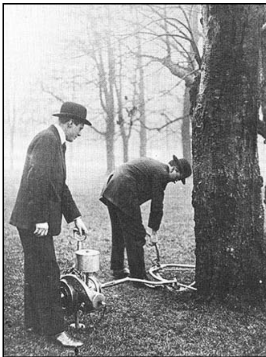
Slika 30: Podiranje drevesa z ločno motorno verižno žago Sector (Mattison, 2007)
