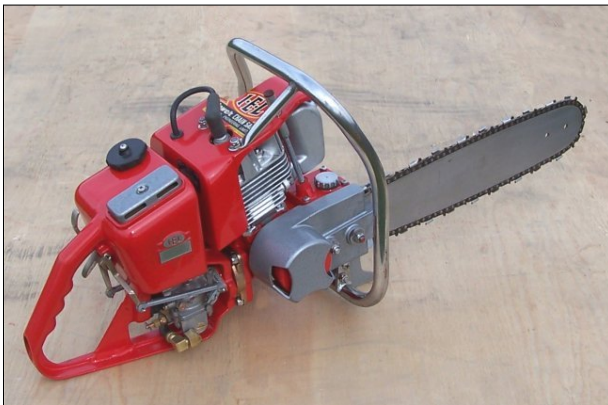
Slika 50: Prva motorna verižna žaga z neposrednim pogonom na svetu (IEL HA) (Chain saw collectors corner, 2007)
