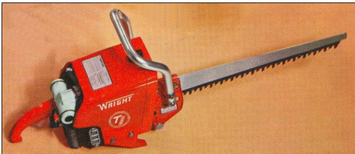
Slika 17: Motorna žaga Wright B-520 iz leta 1963 (Chain saw collectors corner, 2007)
