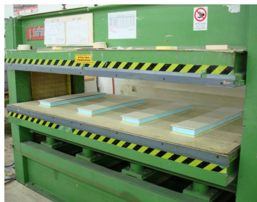
Slika 16: Tehtanje količine nanosa lepila (levo) in stiskanje v hidravlični stiskalnici (desno)
