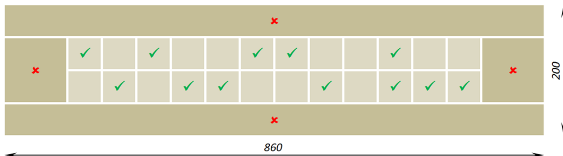
Slika 15: Načrt krojenja elementa iz katerega smo izdelali preizkušance
