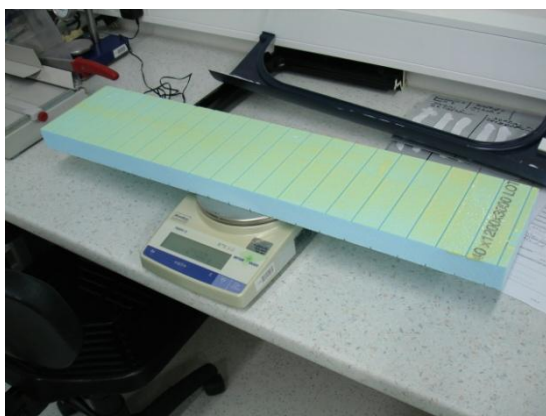
Slika 16: Tehtanje količine nanosa lepila (levo) in stiskanje v hidravlični stiskalnici (desno)
