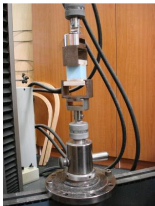
Slika 17: Preizkus razslojne trdnosti na trgalnem stroju Zwick Z100
