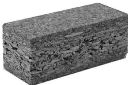
Slika 4: Primer vzorca plosko stisnjene več slojne iverne plošče izdelane z FF smolo
