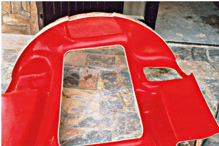
Slika 65: Kalup armaturne plošče
