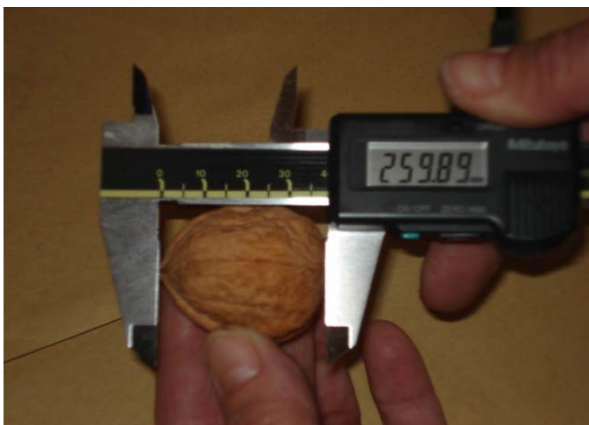
Slika 8: Merjenje višine ploda oreha s pomičnim merilom (Foto: Breg, 2006).
