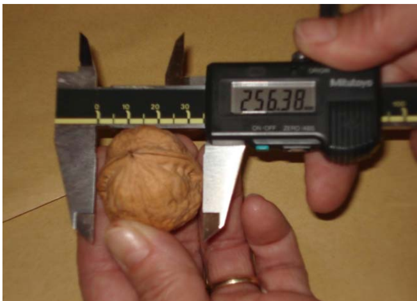
Slika 9: Merjenje širine ploda oreha s pomičnim merilom (Foto: Breg, 2006).
