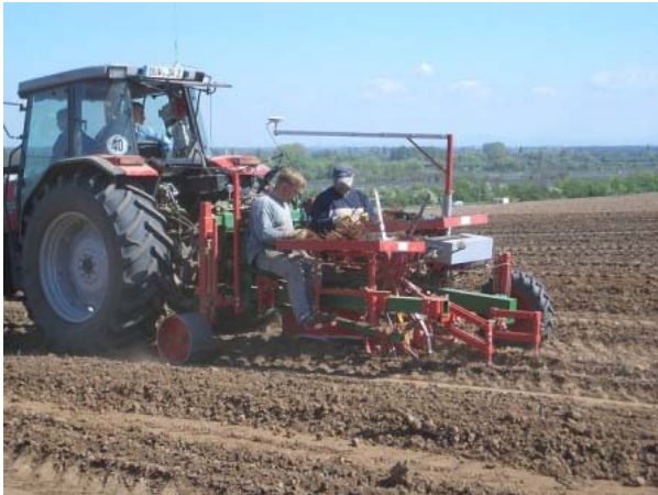
Slika 17: IPS - Drive - satelitsko vodeni sadilni stroj (Wagner..., 2008).
