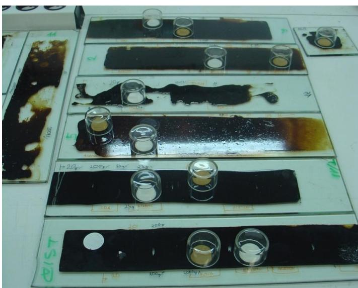
Slika 23: Testiranje odpornosti proti različnim tekočinam
