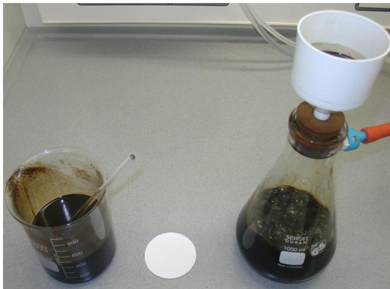
Slika 5: Filtracija utekočinjenega lesa, zmešanega z dioksanom in vodo
