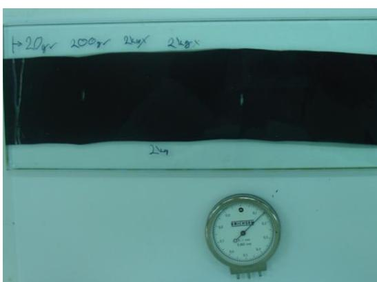
Slika 17: Merilna ura in vzorec za merjenje debeline filma
