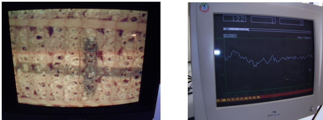
Slika 9: Povečan prerez površine vzorca lesa ki ga merimo (levo) in monitor z zaporedjem širin branik (desno) med merjenjem
