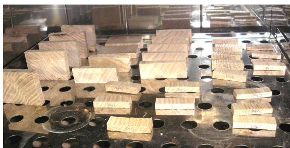
Slika 8: Režnji za določanje vlažnostnega profila po debelini in povprečne vlažnosti hrasta v sušilniku, ki ga predpisuje standard SIST EN 13183-1:2003.
