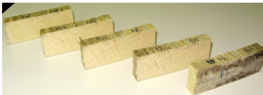
Slika 17: Vzorci smrekovine osušeni na absolutno suho stanje.
