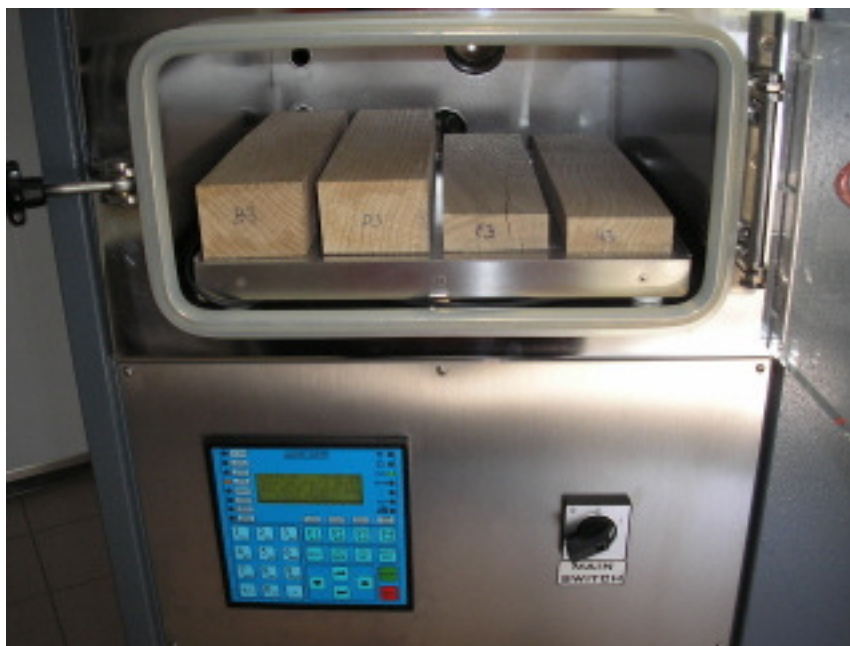
Slika 3: Liofilizator Kambič laboratorijska oprema LIO – 10 s štirimi vzorci hrastovine.
