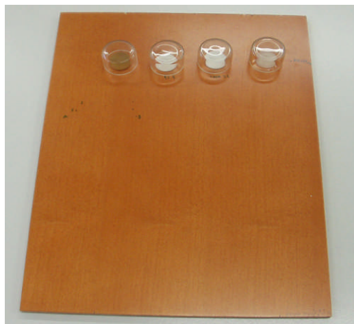
Slika 7: Preizkušanje odpornosti površine proti hladnim tekočinam (podlaga akacija in javor)
