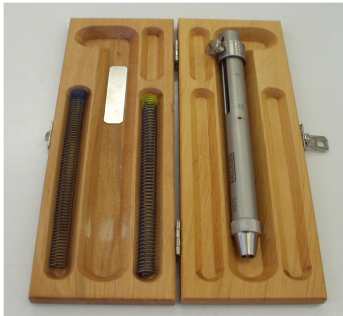
Slika 4: Vzmetni svinčnik za določanje trdote s preskusom z razenjem po SIST EN ISO 1518
