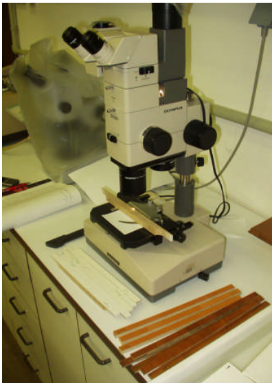
Slika 1: Mikroskop za merjenje debeline premaznega sistema, ter pogled skozi okular (podlaga hrast)
