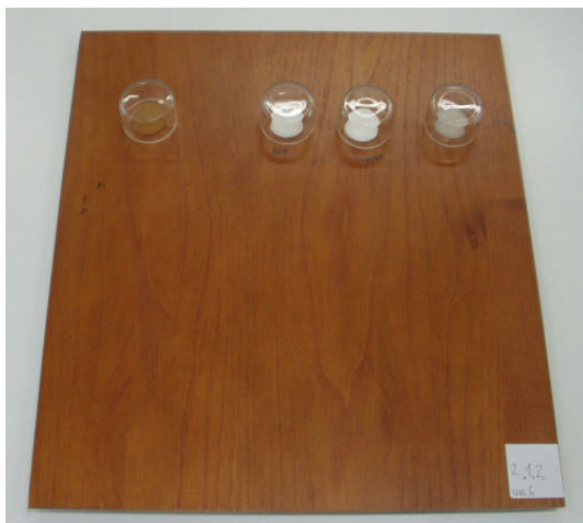
Slika 7: Preizkušanje odpornosti površine proti hladnim tekočinam (podlaga akacija in javor)
