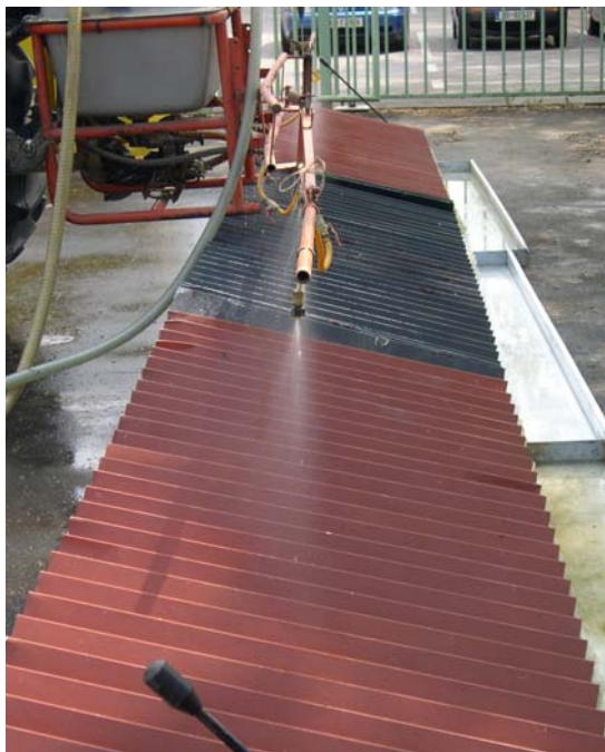
Slika 25: Testirna miza za ugotavljanje prečne porazdelitve škropiva (foto: D. Danijel)
