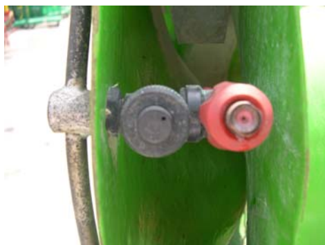
Slika 28: Brezhibno delujoči protikapni mehanizem (foto: D. Danijel)
