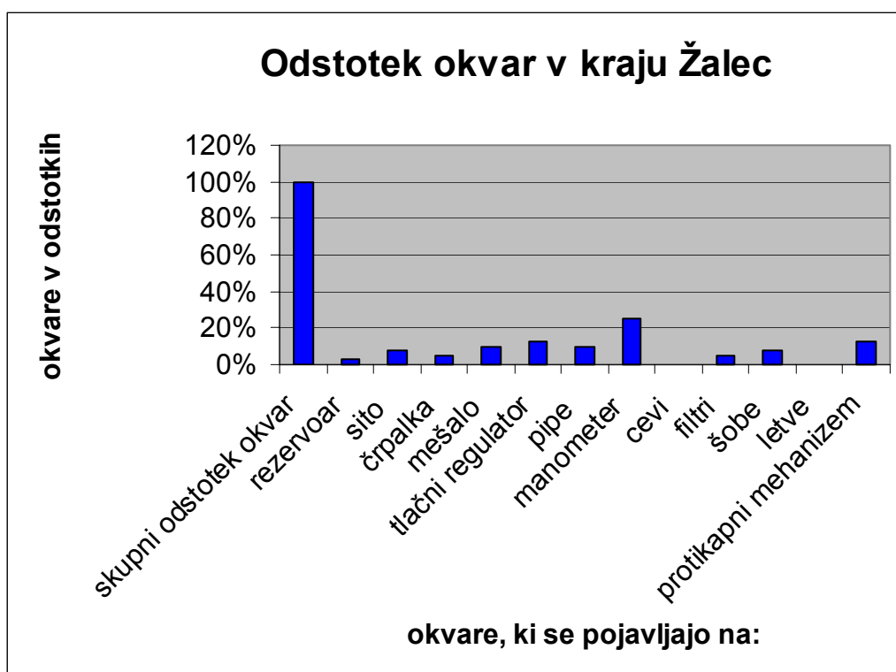
Slika 32: Odstotki okvar na napravah za nanos FFS v kraju Žalec
