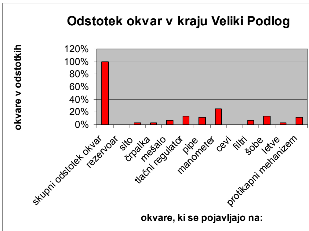
Slika 34: Odstotek okvar na napravah za nanos FFS v kraju Veliki Podlog
