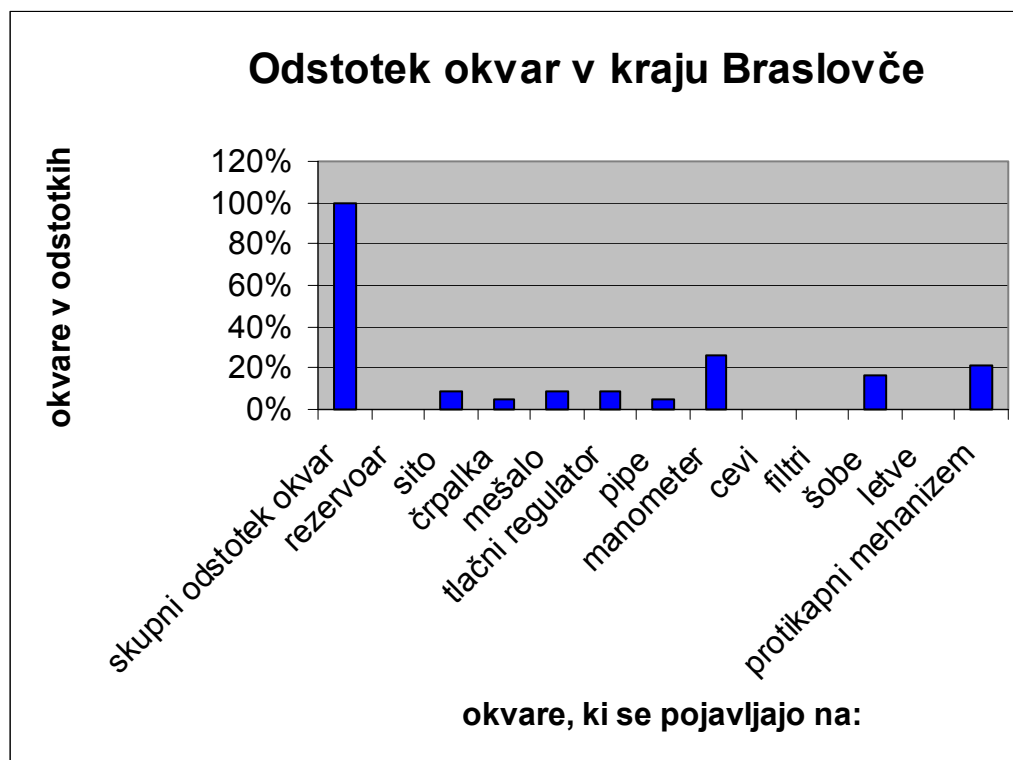
Slika 31: Odstotki okvar na napravah za nanos FFS v kraju Braslovče
