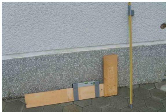
Slika 15: Celotna naprava za merjenje nagiba
