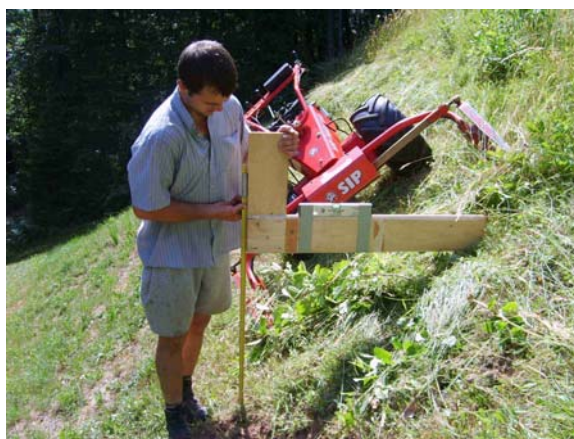
Slika 20: Kosilnica SIP pri nagibu 78 %
