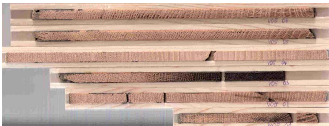
Slika 33: Izvrtki iz objekta Štravsov kozolec
