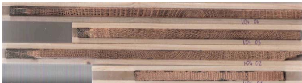
Slika 31: Izvrtki iz objekta Majacov kozolec
