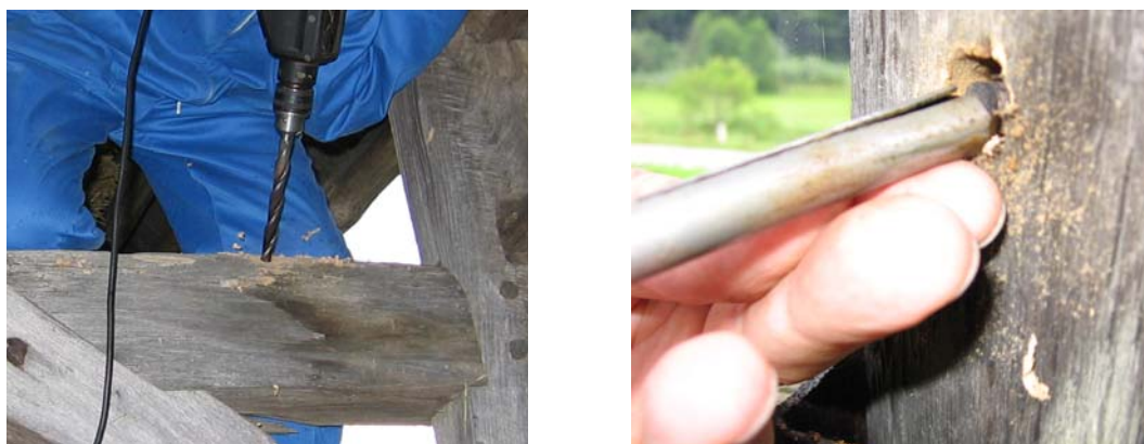
Slika 19: Vrtanje izvrtka - levo, izvlek izvrtka za dendrokronološko analizo - desno (Zaletelj, 2006)
