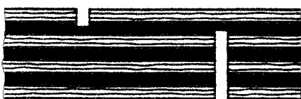
a) strižna trdnost v 1. in 2. lepilnem spoju (par I)
