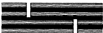
b) strižna trdnost v 3. in 4. lepilnem spoju (par II)
