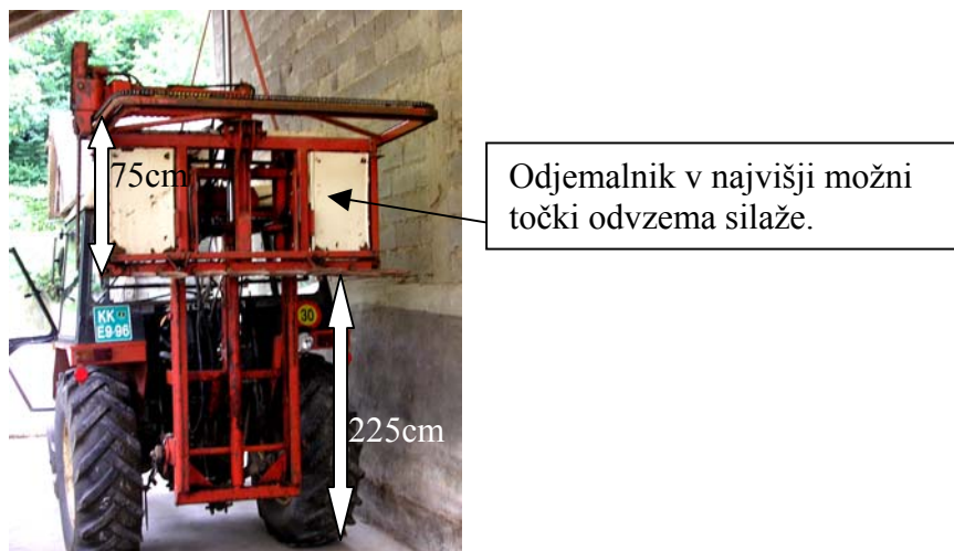
Slika 22: Hidravlični valj na najvišji možni točki (foto: Andrej Dornik).
