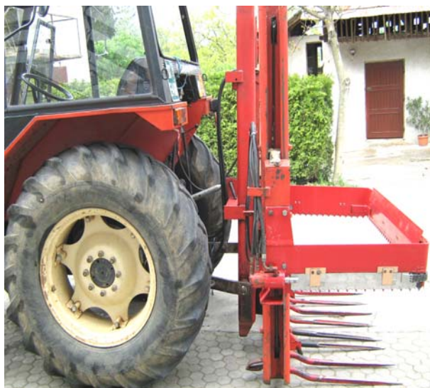
Slika 30: Silažni odjemalnik Trioliet mullos izvedba U 110 s padajočim nožem (foto: Andrej Dornik).
