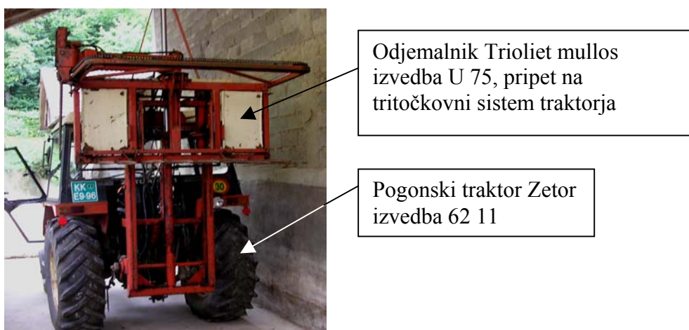
Slika 16: Silažni odjemalnik Trioliet mullos izvedba U 75 s stranskim nožem (foto: Andrej Dornik).
