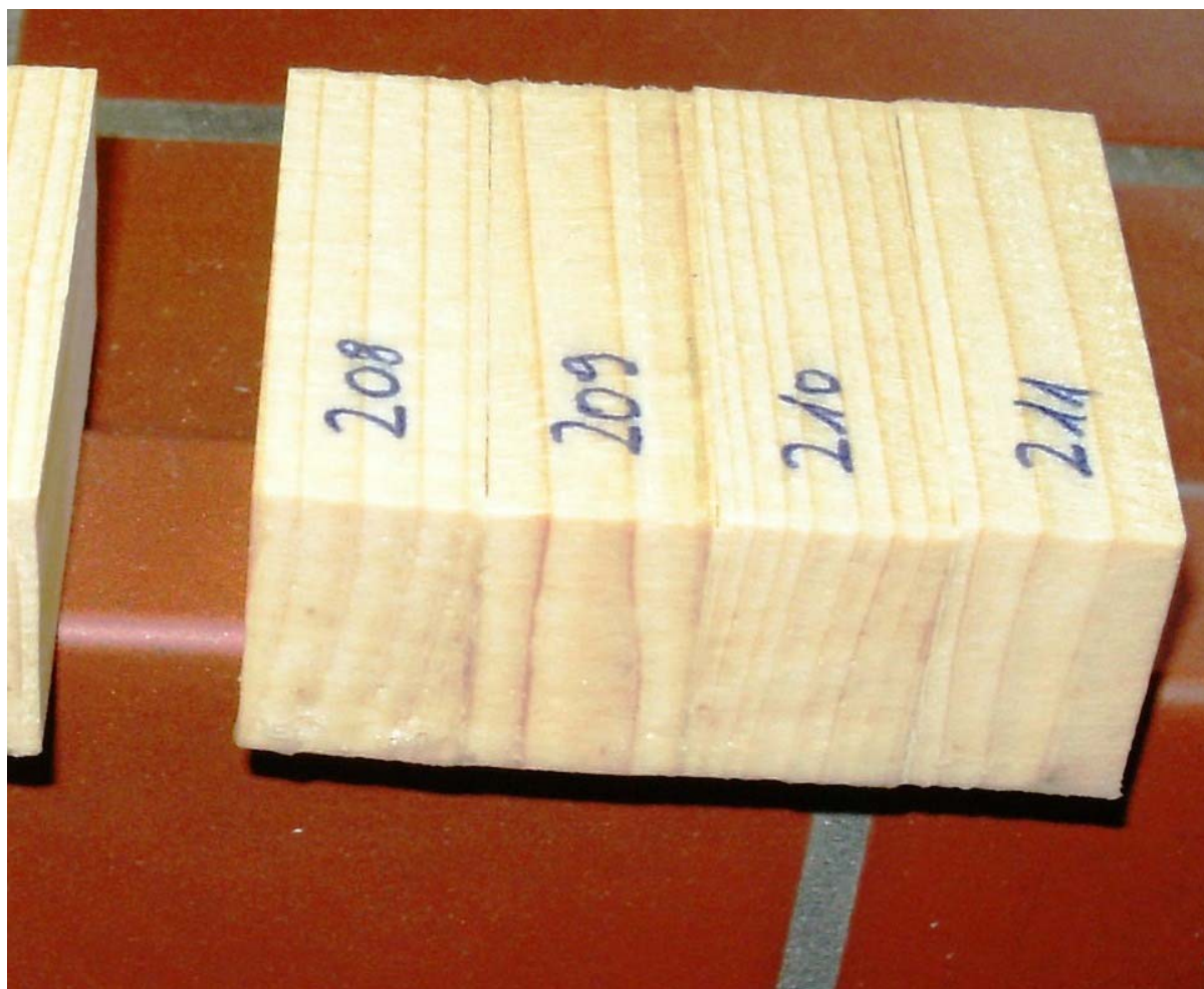
Slika 19: Čela vzorcev zatesnjena z Epolorjem
