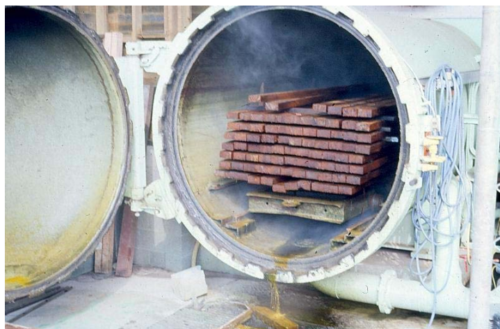
Slika 11: Komora za kotelsko impregnacijo lesa (Pohleven, 2005)
