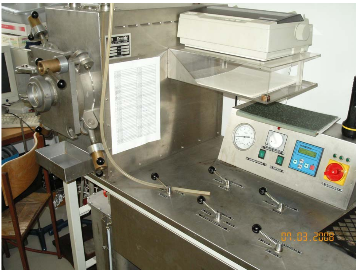
Slika 20: Vakuumsko - tlačna komora Kambič za impregnacijo lesnih vzorcev
