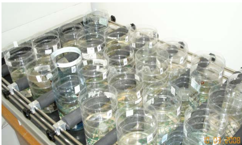
Slika 25: Izpiranje preizkušancev v skladu z modificiranim standardom SIST ENV 1250/2 (1994) na stresalniku
