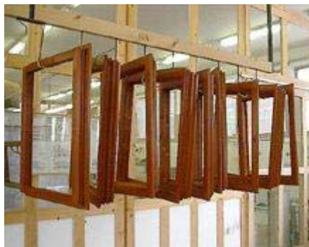
Slika 7: Nanašanje zaščitnih pripravkov z oblivanjem (Pohleven, 2005)
