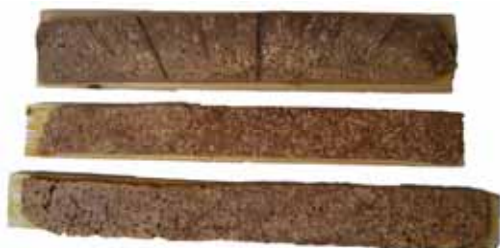
Slika 6: Poškodba navadnega trdoglavca
