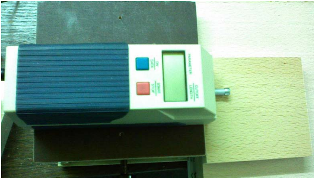
Slika 5: Merjenje hrapavosti s tipalnim merilnikom Mitutoyo »surftest 221«.
