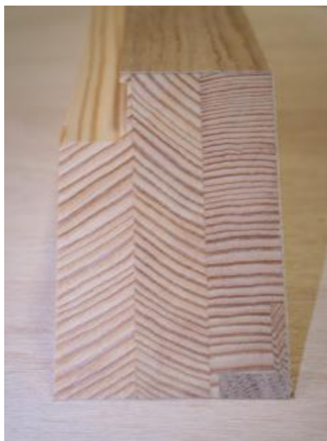
Slika 8 : Furniran lepljen profil za izdelavo okenskih okvirjev
