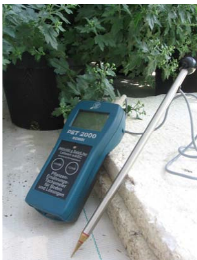
Slika 17: Konduktometer z ustrezno sondo za merjenje aktivne soli v substratu
