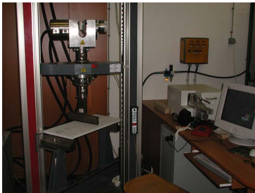
Slika 5: Stroj za preizkušanje upogibne trdnosti, povezan z računalnikom
