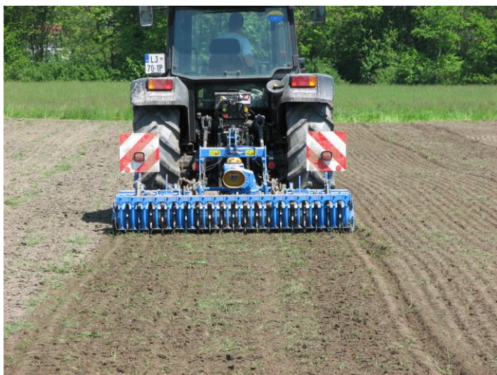
Slika 10: Priprava tal z vrtavkasto brano (Lemken Zirkon 7/250) (foto: M. Geršak, 2008)
