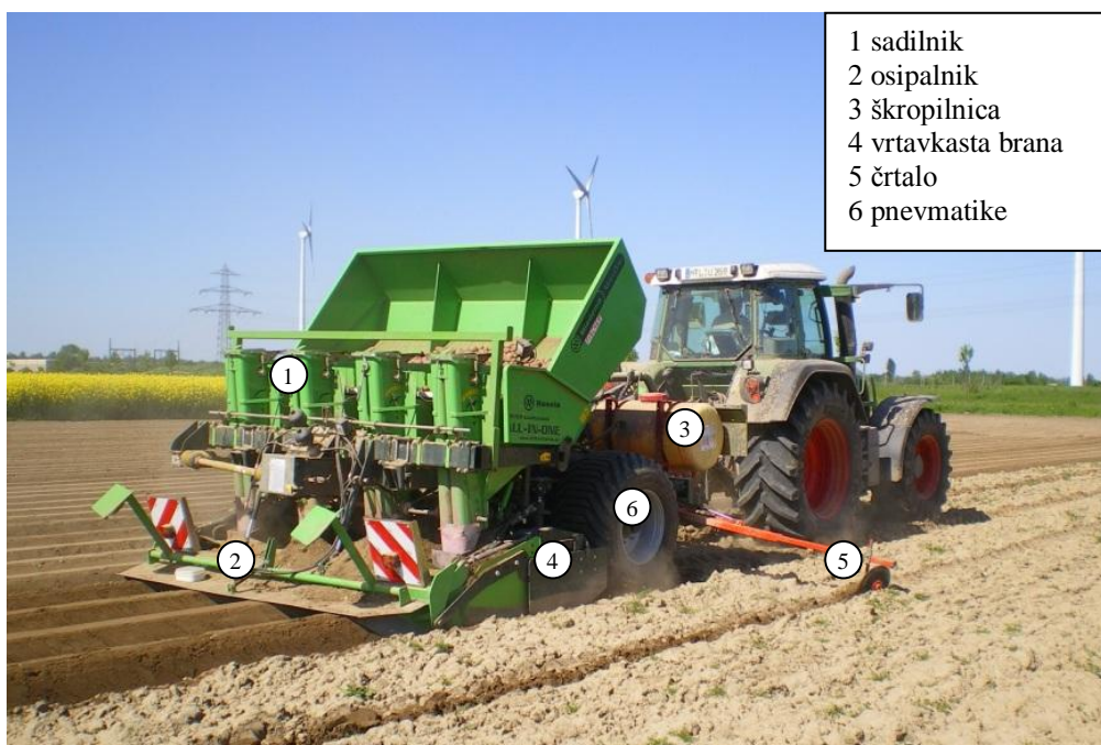
Slika 4: Združeni stroj za sočasno pripravo tal, saditev in končno oblikovanje grebenov (Heiss ..., 2010)
