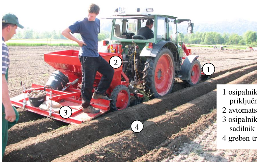
Slika 8: Poseben osipalnik spredaj in avtomatski sadilnik z osipalnikom zadaj na traktorju (foto: M. Geršak)
