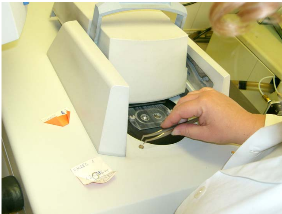
Slika 4: Vstavljanje vzorca v aparat za merjenje T_g z metodo DSC.
