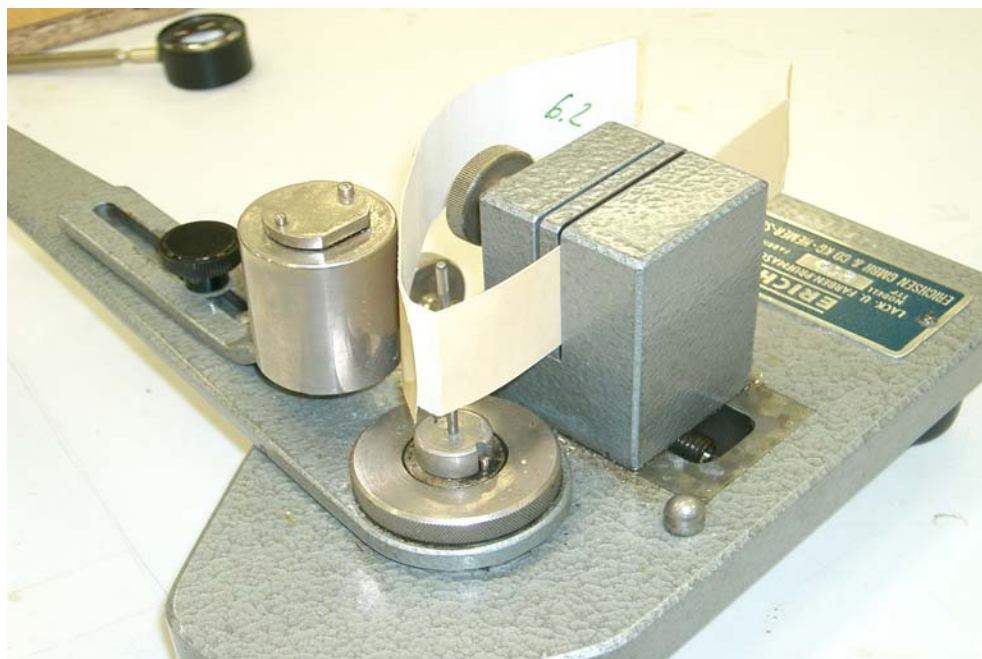
Slika 3: Merjenje prožnosti premaza po standardu SIST EN ISO 1519.
