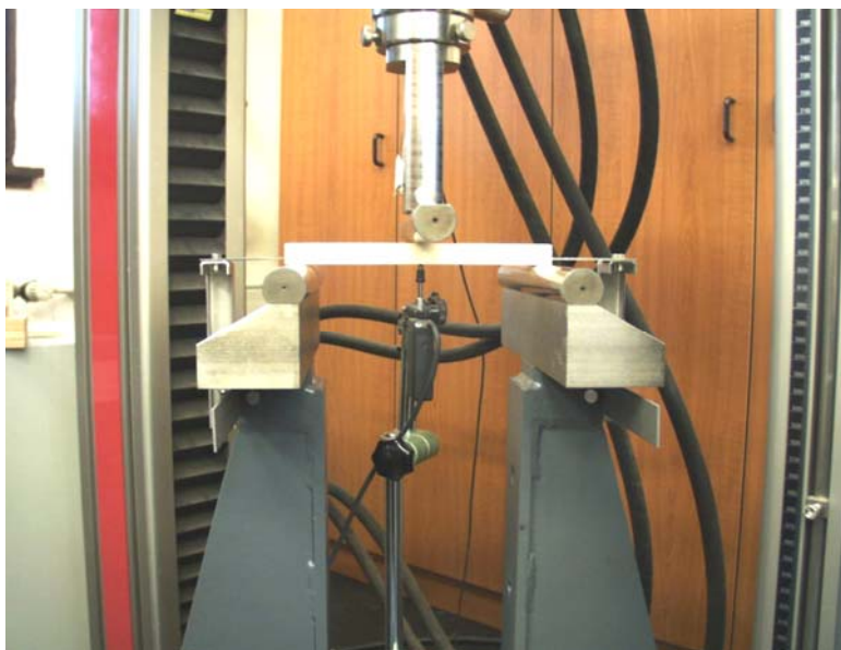
Slika 9: Stroj za preizkušanje upogibne trdnosti – ZWICK Z100.
