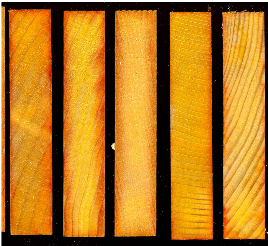
Slika 5: Globina penetracije borovih ionov v vzorcih, impregniranih z zaščitnim sredstvom Silvanolin visoke koncentracije
