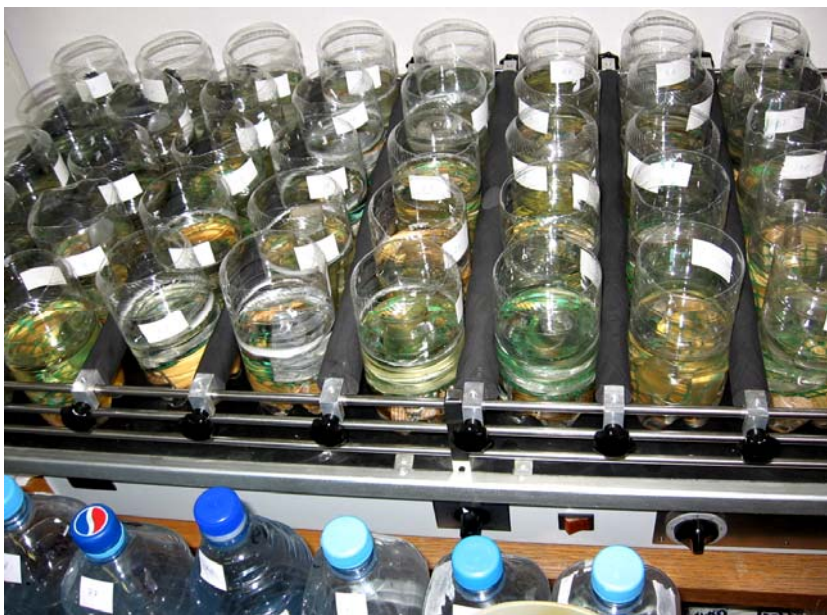
Slika 10: Izpiranje vzorcev na električnem stresalniku KAMBIČ
