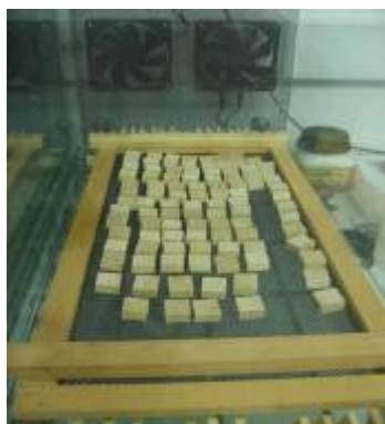
Slika 6: Prikaz steklene komore za uravnovešanje z vzorci in ventilatorji
