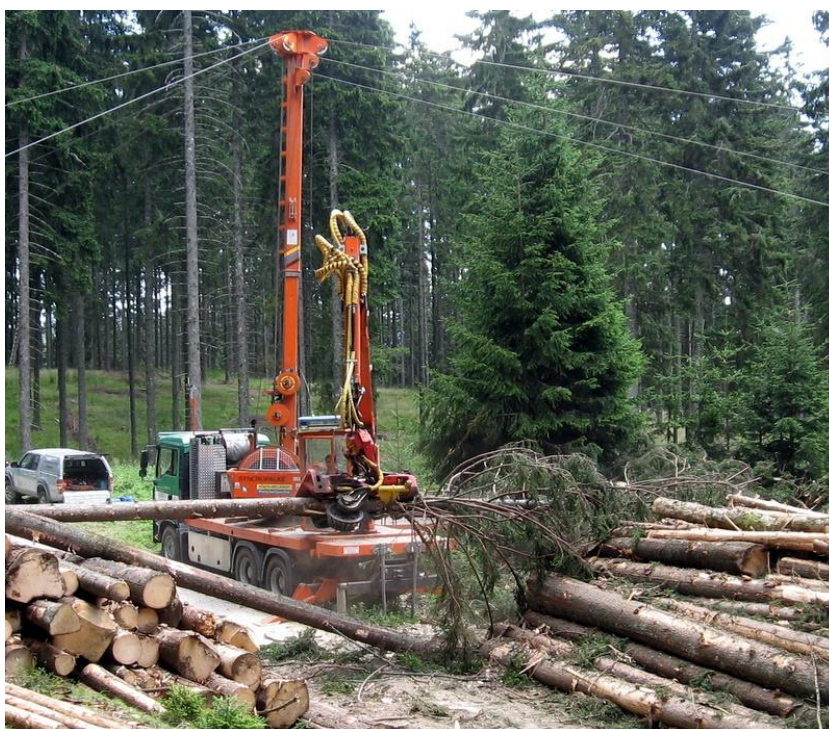
Slika 2: Žičnica Syncrofalke na kamionu MAN (foto: Grubišič M. 16. 07. 2009)
