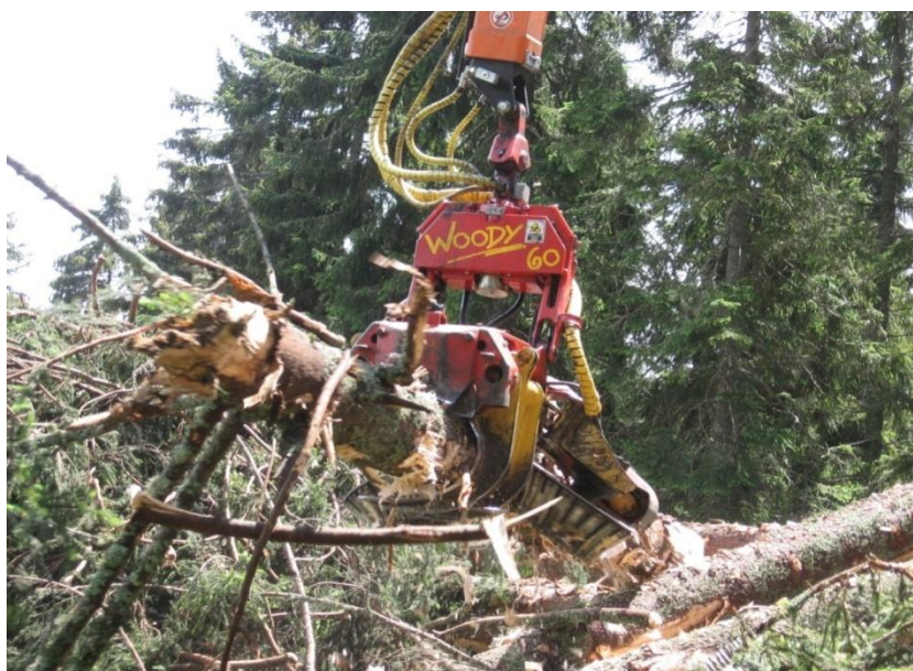
Slika 4: Procesorska glava Woody 60 na hidravlični roki Liv (foto: Grubišič M. 16.07.2009)
