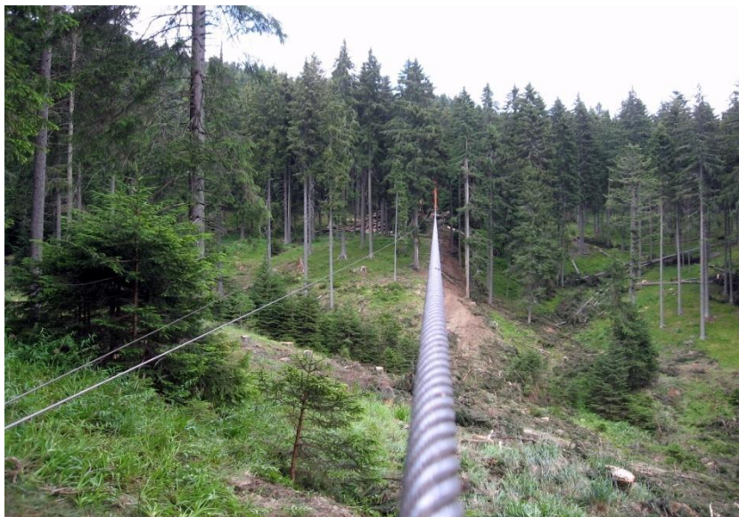
Slika 1: Postavljena linija za žično spravilo s Syncrofalke (foto: Grubišić M. 16. 07. 2009)
