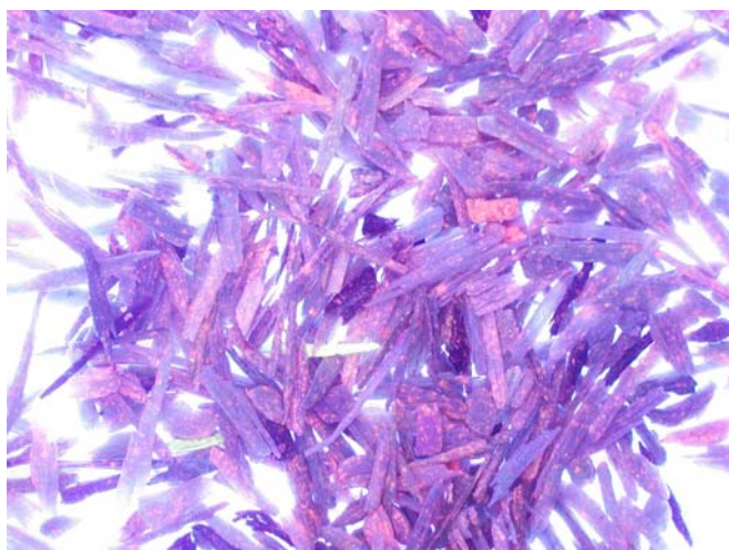
Slika 2: Oblepljeno iverje pod mikroskopom s fluorescentno lučjo
