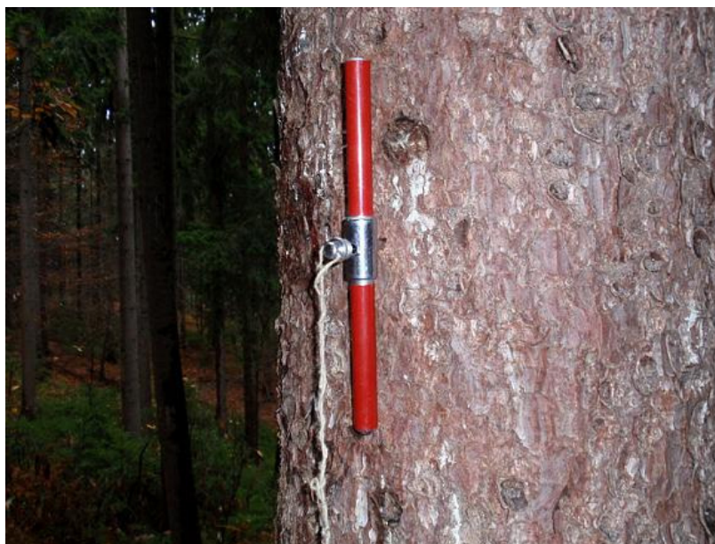
Slika 21: Prikaz vrtanja s prirastnim svedrom na terenu (november 2008)
