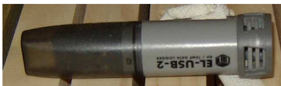
Slika 13: EasyLog USB ključ za spremljanje relativne zračne vlažnosti in temperature
