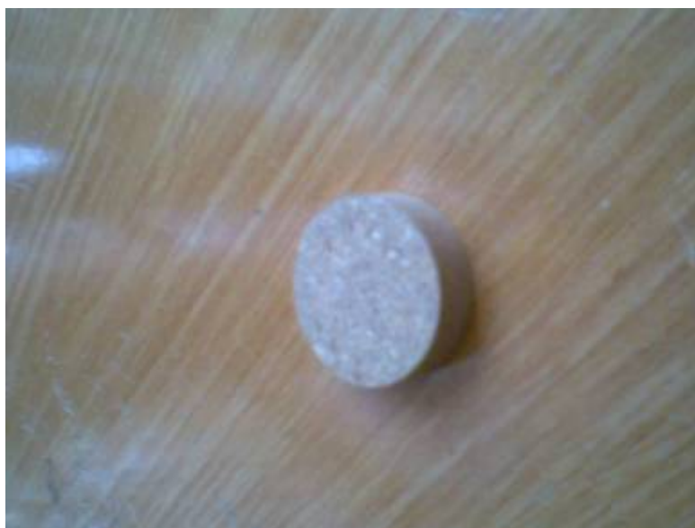
Slika 13: Stisnjena »tableta« za analizo XRF
