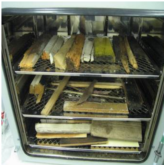
Slika 14: Odslužen les v sušilniku
