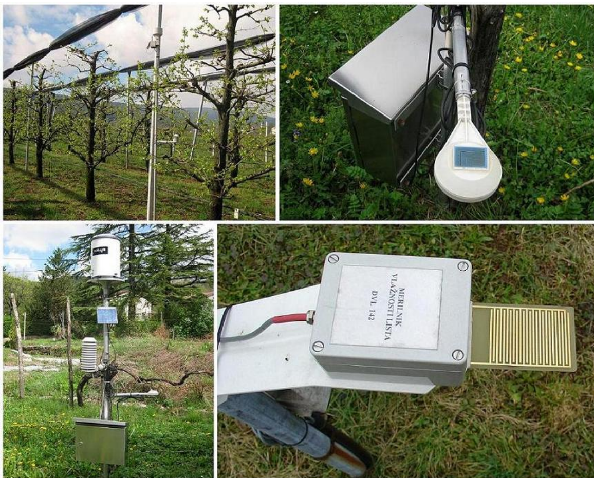
Slika 10: Vremenska postaja v Kromberku (levo spodaj), merilnik TOL na tej postaji (desno zgoraj), postaja Bilje FURS (levo zgoraj) (foto: Hren), merilnik TOL v AMP Bilje (desno spodaj) (foto: ARSO)
