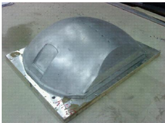
Slika 34: Prikaz aluminijastega modela obloge v kolesarnici
