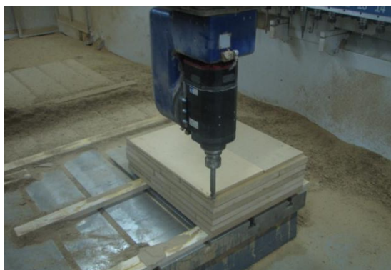
Slika 8: Ročna postavitev agregata stroja z rezkarjem v izhodiščno točko
