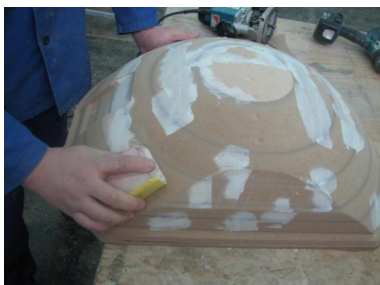
Slika 12: Ročna obdelava lesenega modela
