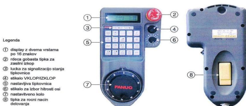
Slika 25: Prikaz in razlaga delov mobilne tipkovnice (Poseidon, 2006)
