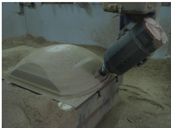
Slika 10: Fina strojna obdelava
