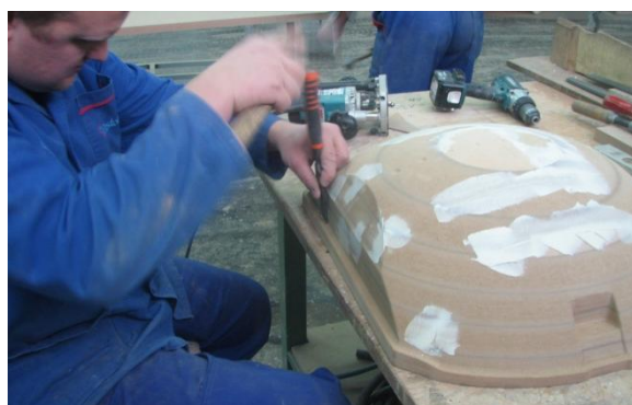
Slika 13: Ročna obdelava tehnološkega robu
