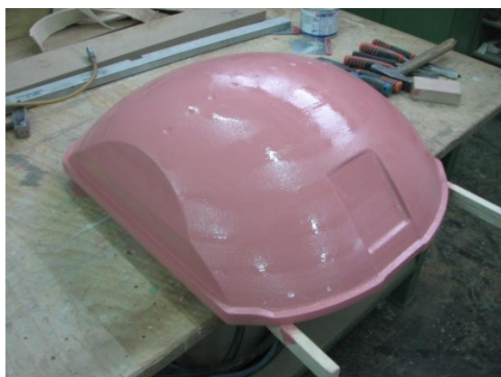
Slika 33: Prikaz lesenega modela obloge v kolesarnici
