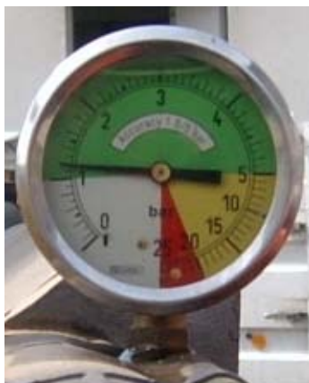
Slika 17: Glicerinski manometer za škropilnice (foto: T. Janežič)
