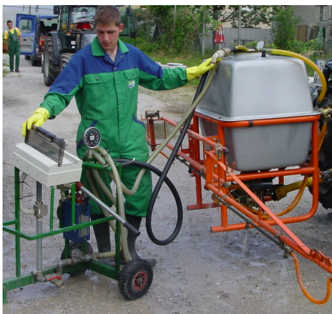
Slika 21: Merjenje pretoka črpalke (foto: T. Janežič)
