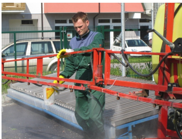
Slika 22: Merjenje pretoka posamezne šobe (foto: Š. Kuhar)
