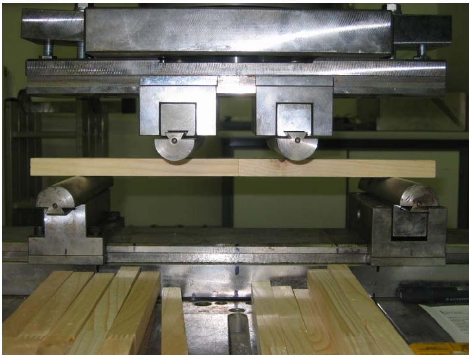
Slika 5: Naprava za štiri točkovni upogib, Zwick (Igmatt, 2007)
