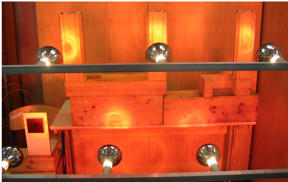
Slika 31: Infrardeče žarnice obsevajo vzorce in merilnik temperature
