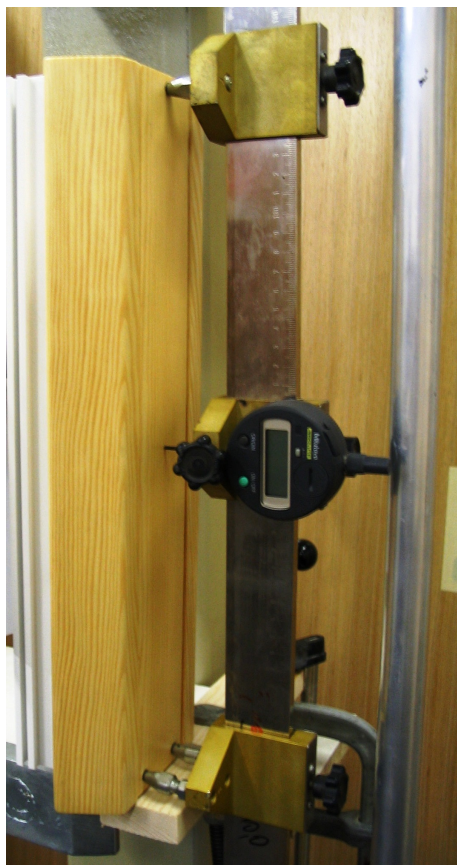
Slika 32: Merjenje upogibanja lesene obloge
