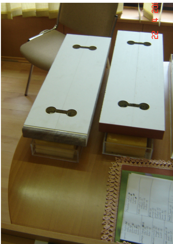
Slika 14: Preizkušanje odpornosti lepilnega spoja na vlago
