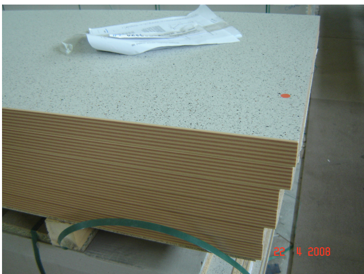
Slika 7: Delovna plošča izdelana iz iverne plošče oblepljena z laminatom, prednji rob obdelan z ABS trakom debeline 2mm
