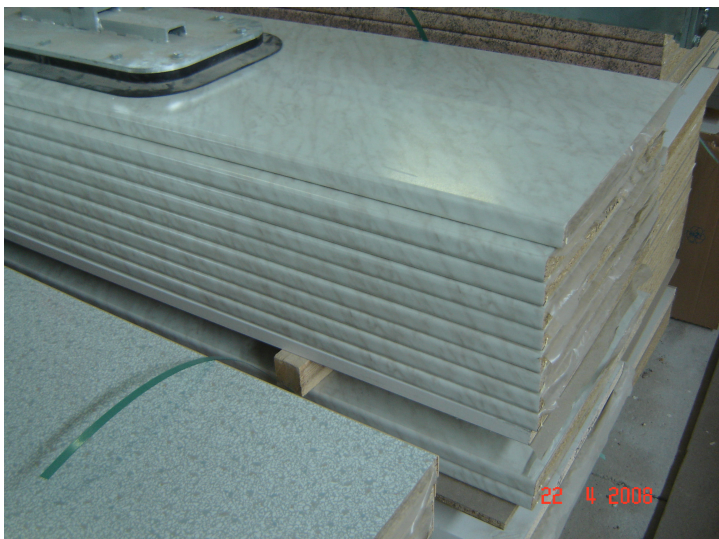
Slika 8: Delovna plošča izdelana iz iverne plošče, oblepljena z laminatom, prednji rob »postforming«
