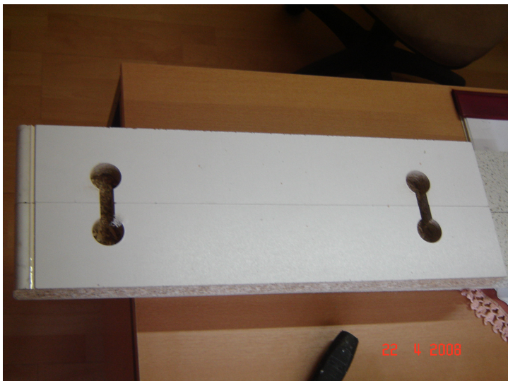
Slika 11: Izvrtine za spojno okovje
