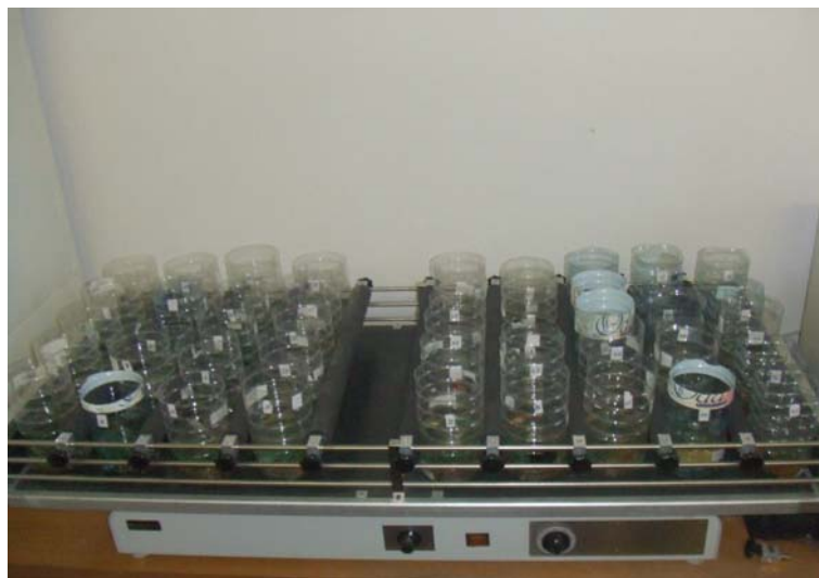
Slika 9: Izpiranje vzorcev po impregnaciji s pomočjo stresalnika
