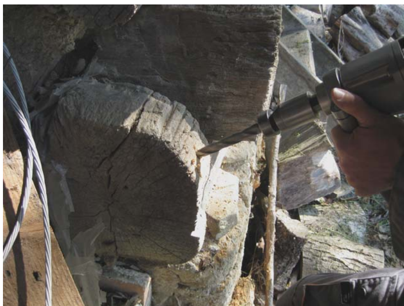
Slika 20: Odvzem vzorcev za dendrokronološko analizo.
