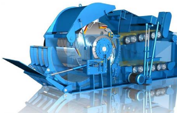
Slika 9: Bobenski sekalnik BRUKS 805 CT ( Bio Fuels , 2007)
