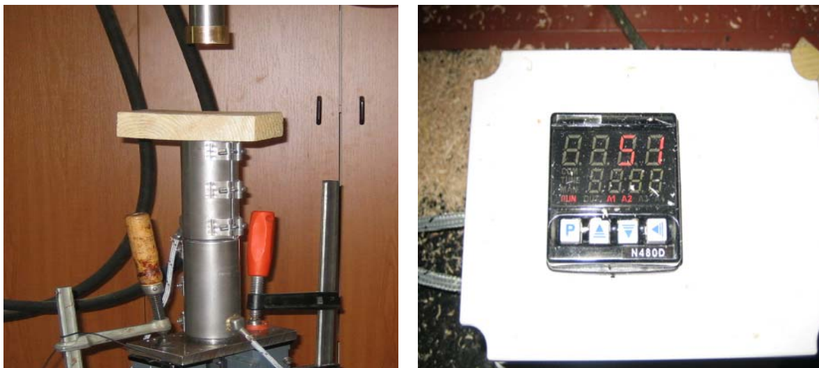
Slika 16: Cilindrično grelni telo (levo) in mikroprocesorski regulator temperature (desno)
