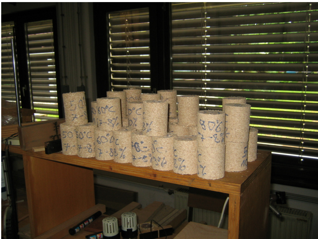
Slika 20: Označeni in odloženi stiskanci po opravljenih meritvah
