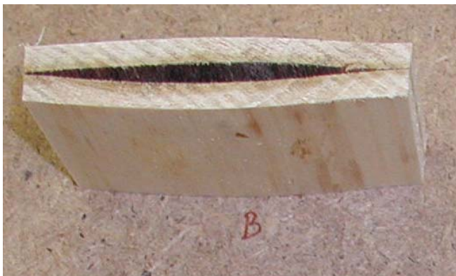
Slika 11: Napaka pri lepljenju lamel zelenega bora
