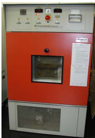
Slika 7: Klima komora za kondicioniranje lesa v normalnih pogojih ( T = 20\text{ }^{\circ}\text{C} , \varphi = 65\% )
