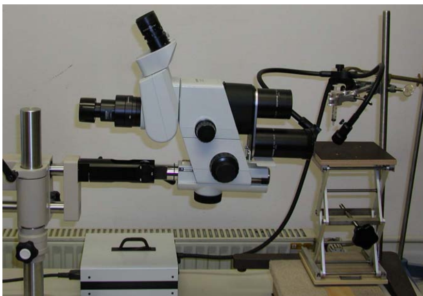
Slika 13: Oprema za ugotavljanje kontaktnega kota
