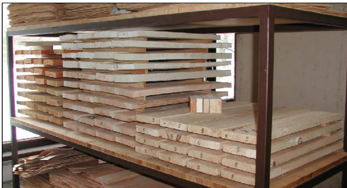
Slika 8: Prikaz sušenja lesa v laboratoriju ( T = 22^{\circ}\text{C} , 35 – 55 % relativna zračna vlažnost)
