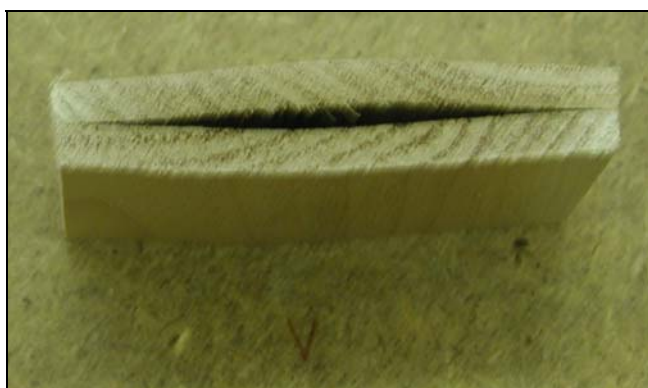
Slika 10: Napaka pri lepljenju lamel vrbe
