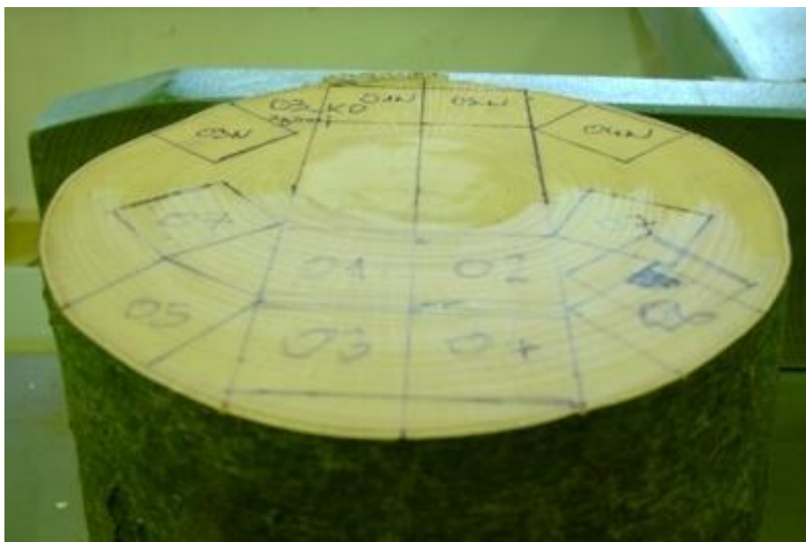
Slika 4: Primer hlodiča z označenimi predvidenimi lokacijami za odvzem vzorcev.
